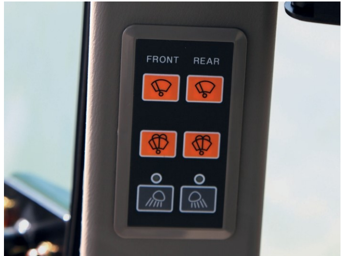
Het bedieningspaneel voor verlichting/ruitenwischer bevindt zich rechts van de bestuurder, op de raamstijl. Alle bedieningen binnen handbereik.
