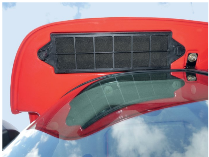
Filters en -vloeistoffen zijn gemakkelijk bereikbaar zonder dat speciaal gereedschap nodig is.
